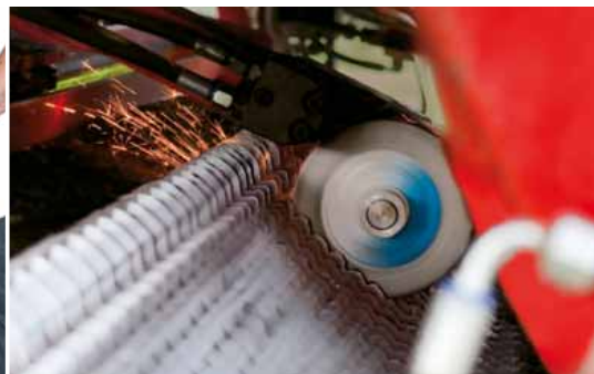
AUTO CUT – Vollautomatische Messerschleifeinrichtung direkt am Ladewagen.
