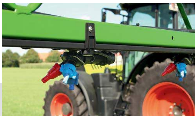
Atskiro purkštuko įjungimas „AmaSwitch“
