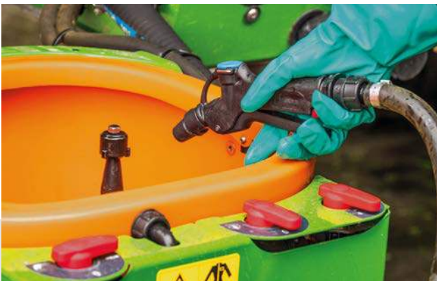
✔ Dešinėje įleidimo rezervuaro pusėje yra į standartinę įrangą įeinantis purškimo pistoletas.
