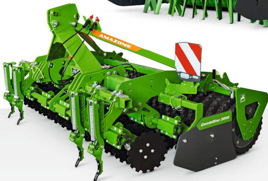
Prie „CombiDisc“ pritvirtintas kompaktiškas diskinis skutiklis vagutėms paruošti
