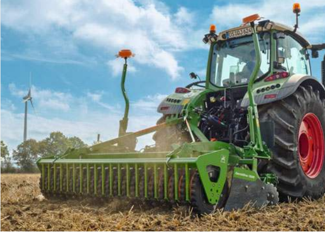
Sumontuotas kompaktiškas diskinis skutiklis „CombiDisc 3000“, naudojamas atskirai
