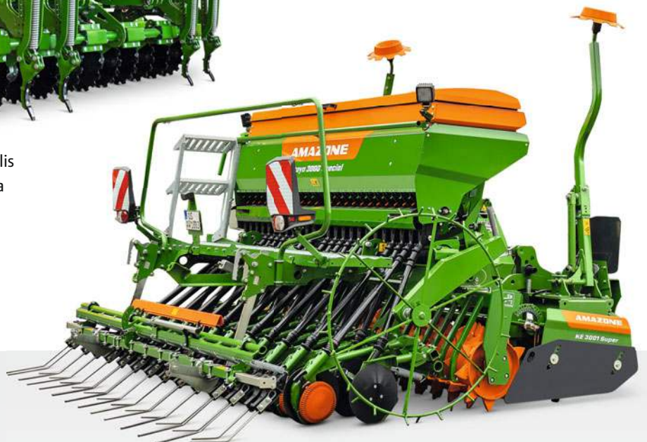
Rotacinės akėčios „KE 3001 Super“ su pakabinama sėjamąja „Cataya 3000 Special“
