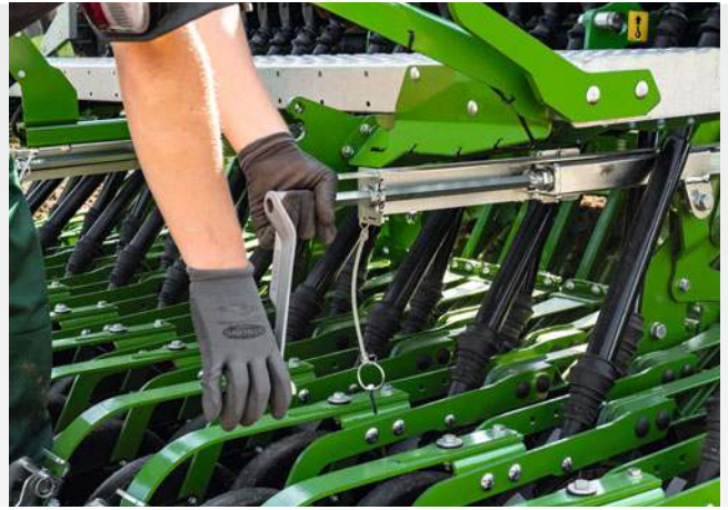
Paprastai nustatomas įterpimo gylis kairėje ir dešinėje „Cataya Special“ galinėje pusėje
