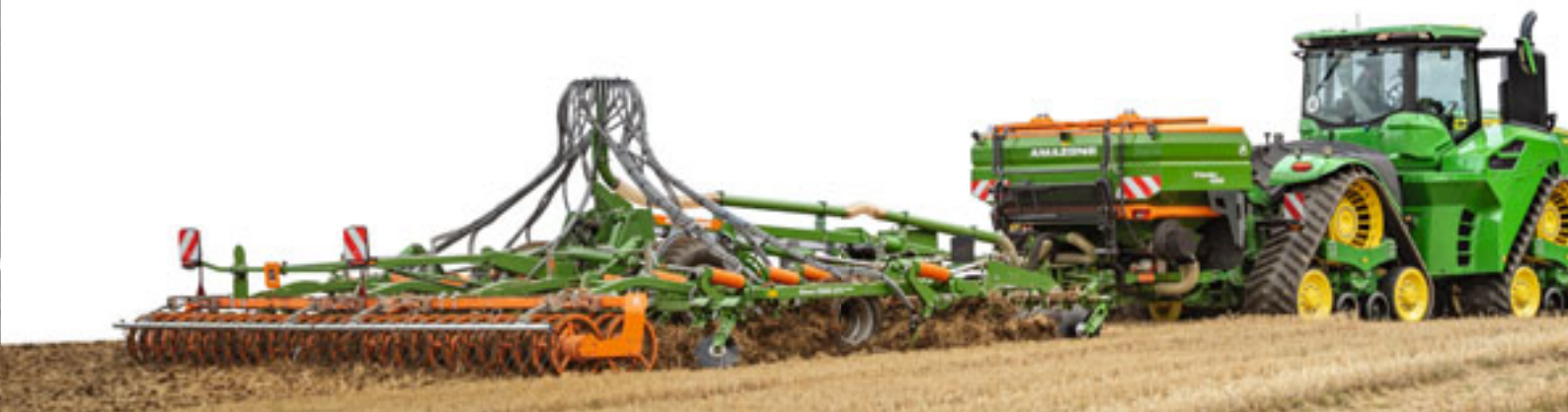
„XTender“ 4200 pakabinamas bunkeris, kurio talpa 4200 l su „Ceus“ 7000-2TX
