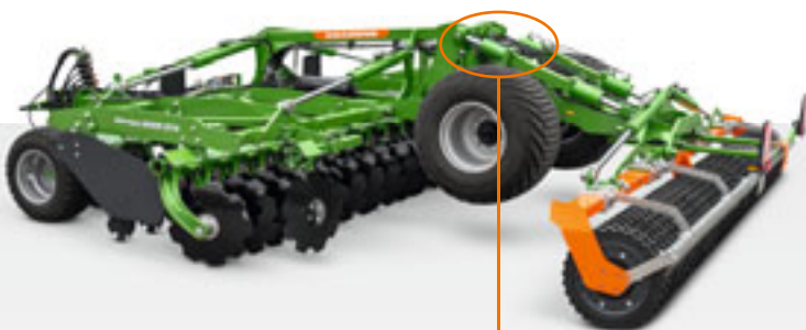
Ant „Certos“ 6002-2TX įrengtas hidraulinis viršutinis prikabinimo strypas
