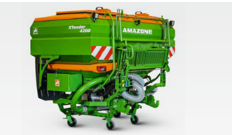
„XTender“ 4200 pakabinamas bunkeris, kurio talpa 4200 l
