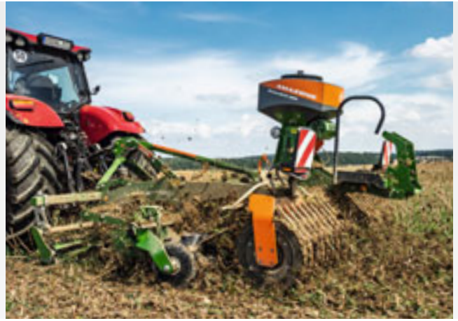
„Catros“ XL 3003 su „X-Cutter“ disku, peiliniu volu ir „GreenDrill“
